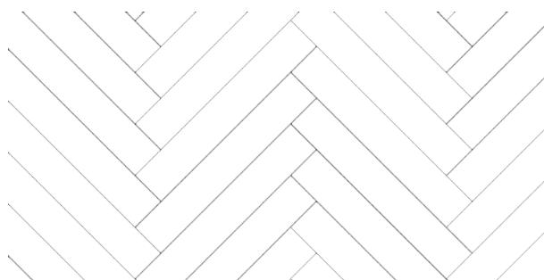
Chevrons : on retrouve ici des barres / éléments de gauche et de droite en alternance dans le paquet. Une règle / ruban métallique en inox facilite la pose de la première rangée. Il convient ici de s'assurer de l'alignement parfait et précis.
