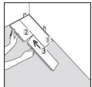
Für alle weiteren Elemente der ersten beiden Reihen gehen Sie genauso vor. Das angegebene Verlegeschema sollte dabei eingehalten werden.
