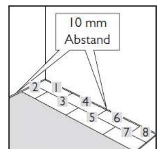
Anschließend kann Element für Element verlegt werden.
