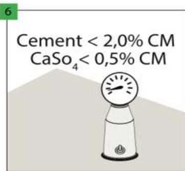
Dans le cas d'une base de ciment, sa teneur en humidité doit être inférieure à 2,0% et dans le cas de l'anhydrite, inférieure à 0,5%. Dans le cas d'une installation avec chauffage du plancher, les valeurs ci-dessus doivent être de 1,8% et 0,3%, respectivement.
