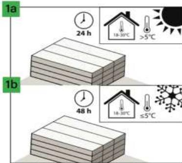
Dans le cas de températures  $>5^{\circ}\text{C}$  pendant le transport, le temps d'acclimatation dans une pièce où la température est comprise entre 18 et  $30^{\circ}\text{C}$  doit être de 24 heures (dans la pièce où la pose sera effectuée). Par contre, dans le cas de températures  $\leq 5^{\circ}\text{C}$  pendant le transport, le temps d'acclimatation doit être de 48 heures dans une pièce dont la température est comprise entre 18 et  $30^{\circ}\text{C}$ .
