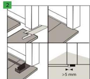
Couvrir les dilatations le long des murs avec des plinthes décoratives, en les collant ou en les fixant à l'aide de clips spéciaux. Il est recommandé d'utiliser des plinthes de la marque Arbiton dédiées à un modèle donné de lame de parquet, ce qui garantit une excellente harmonie des couleurs et un revêtement résistant aux rayures.
