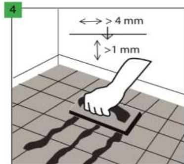
En cas d'installation sur une base carrelée en céramique, jointoyez les joints avec des espaces plus larges que 4 mm et plus profonds que 1 mm avec un composé à joints durable tel qu'un coulis en caoutchouc.
