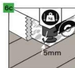
Dans le cas d'objets lourds sur le sol (tels que les meubles de cuisine, îlot de cuisine, armoires encastrées et autres meubles fixés au mur), il est nécessaire de laisser des joints d'expansion de 5 mm entre eux. Pour laisser des joints de dilatation, nous recommandons les méthodes suivantes :
