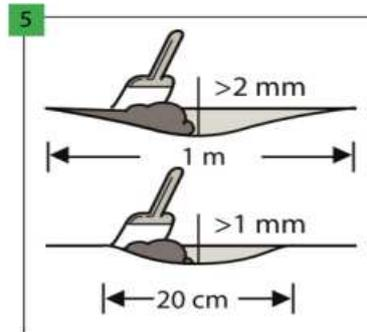
Assurez-vous que la base est complètement plate. Toutes les irrégularités du sous-plancher excédant 1 mm et excédant 20 cm de longueur, ou excédant 2 mm et excédant 1 m de longueur, doivent être nivelées. Vérifiez si vous devez utiliser un apprêt ou un matériau isolant. Pour préparer la base parfaite, appliquez un mortier de ciment ou un composé autonivelant sur toute la surface.
