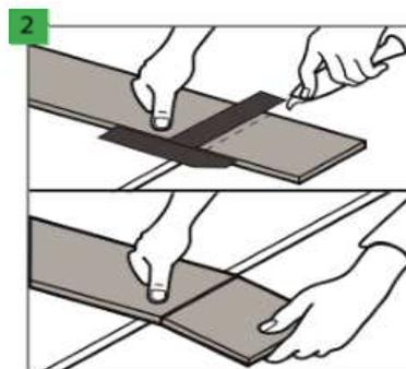
Pour une coupe supplémentaire des planchers, avec un couteau bien aiguisé, coupez la couche supérieure et cassez rapidement une partie du panneau en le posant sur le bord. De plus, les panneaux de plancher sont faciles à couper avec une scie électrique.
