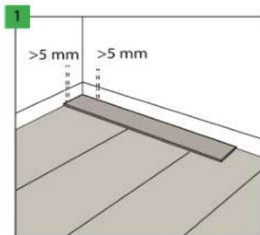
Laissez des espaces de 5 mm autour du périmètre des murs pour compenser l'expansion linéaire du sol. La surface maximale pouvant être posée sans espace supplémentaire est de 200 m<sup>2</sup>. Pour les surfaces plus grandes, augmentez tous les espaces à 10 mm. La longueur maximale de la surface du sol dans une direction pouvant être posée sans joint de dilatation supplémentaire est de 20 m. Dans le cas d'une plus grande longueur, augmentez tous les espaces à 10 mm.
