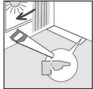
Halten Sie bereits bei der ersten Elementreihe und anschließend zu allen weiteren aufsteigenden Bauelementen (Wände, Säulen, Heizungsrohre etc.) mindestens 10 mm Abstand. Dies kann durch Abstandskeile bewerkstelligt werden. Nichtbeachtung führt zu einem eingespannten Zustand der schwimmenden Konstruktion. Dies führt zu Aufwölbungen im Bodenbelag und in der Folge ggf. zur Zerstörung des Bodenbelags.
