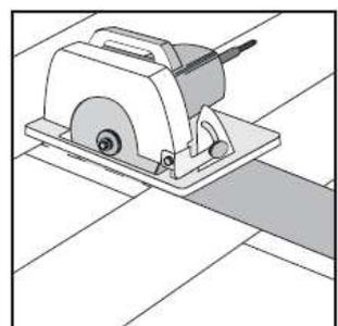
Zur Vorbereitung des Ersatzelements schneiden Sie sowohl an der Stirn-, als auch an der Längsseite vorsichtig die Feder ab, sodass die Verriegelungsnut nicht beschädigt wird. Nun tragen Sie den D3 Weißleim auf die Längs-, und Stirnseite des präparierten Elements sowie auf dem verbleibenden Clickmechanismus der angrenzenden Elemente auf. Anschließend führen Sie das präparierte Element von der Nut- zur Federseite hin ein und beschweren es, bis der Leim abgebunden hat.
