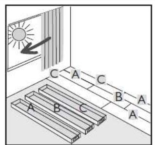
Schneiden Sie die Elemente der letzten Reihe auf Maß. Wenn das Element nicht von oben eingewinkelt werden kann, schneiden Sie die Nase der unteren Nutwange ab, und tragen Sie etwas wasserfesten D3-Weißleim auf. Anschließend setzen Sie die Diele einfach ein. Berücksichtigen Sie hierbei auch den einzuhaltenden Randabstand.
