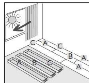
Beginnen Sie mit der Verlegung gemäß Verlegeplan in der linken Ecke der längsten Raumwand. Die Click-Verbindung an der Stirnseite und der Längsseite zu der angrenzenden Wand ist abzuschneiden. Dies gilt auch bei allen folgenden Elementen, die unmittelbar an Wände grenzen.
