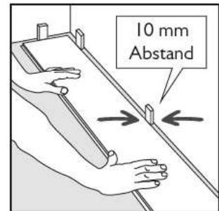
Verlegen Sie die ersten beiden Reihen nach dem abgebildeten Schema.
