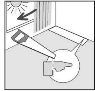
Wir empfehlen Ihnen bei der Verlegung der ersten Reihen einen ausreichenden Abstand zum Wandverlauf (ca. 10 – 15 cm) als freien Arbeitsraum einzuhalten. Anschließend richten Sie die ersten beiden, verlegten Reihen ordnungsgemäß unter Einhaltung des Wandabstandes (10 mm) zu den Wänden aus und platzieren die Abstandshalter.
